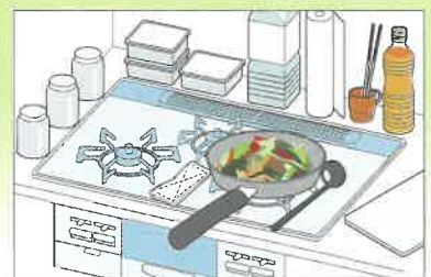
周辺に可燃物が置かれた危険な例
